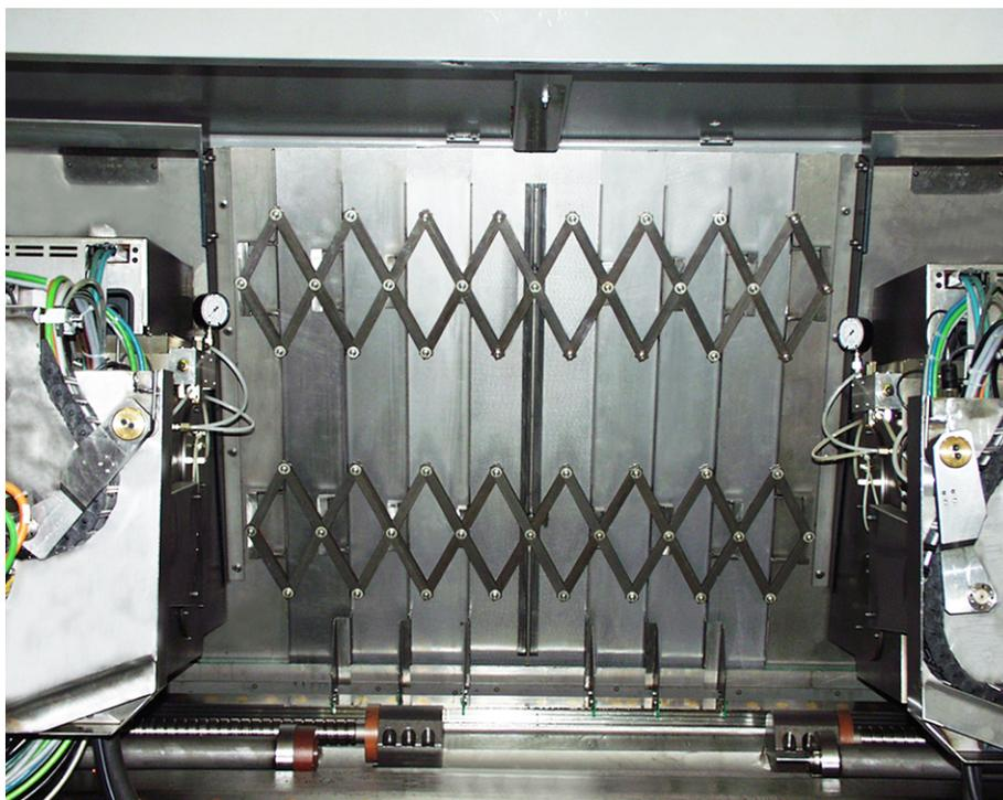
Exemple : Protecteur télescopique et pantographe (dans la zone d'entraînement)
