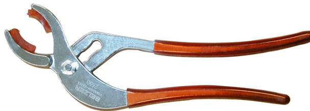
Beispiel: Spezial-Zange zum Anziehen der Energie- und Geberanschlüsse an den Motoren
