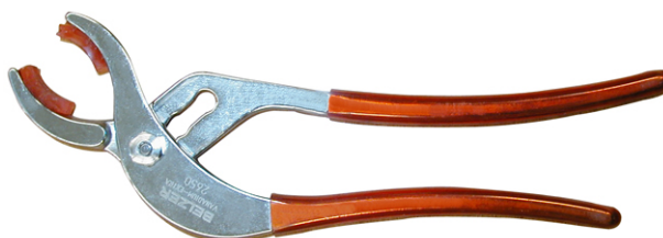
Exemple : Pince spéciale pour serrer les raccords des énergies et des codeurs moteurs
