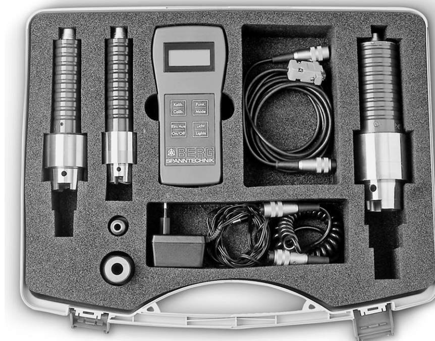
Beispiel: Spannkraftmesssystem Fa. Berg
