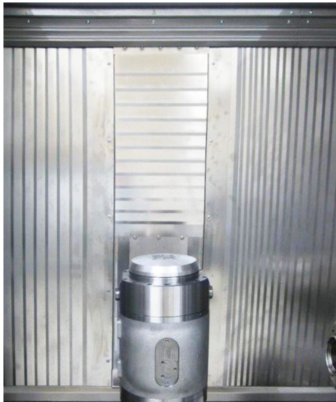
Beispiel: Werkzeugträger 1 mit Motorfrässpindel G3xx/G4xx/G5xx
