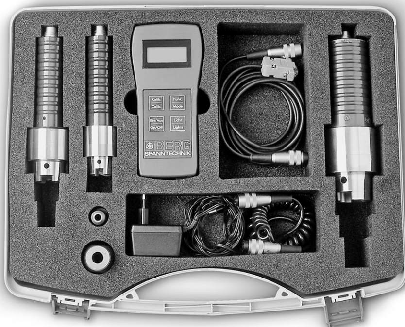
Beispiel: Spannkraftmesssystem Fa. Berg
