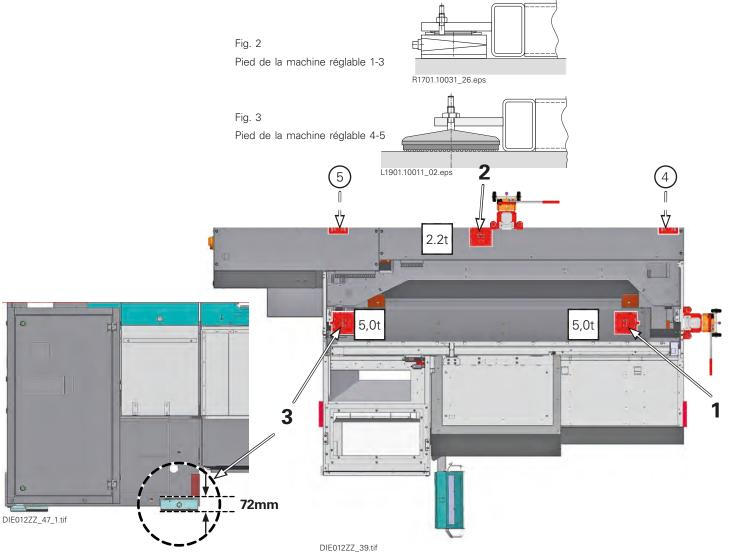
Fig. 5 Fig. 4 "Mise à niveau de la machine"
