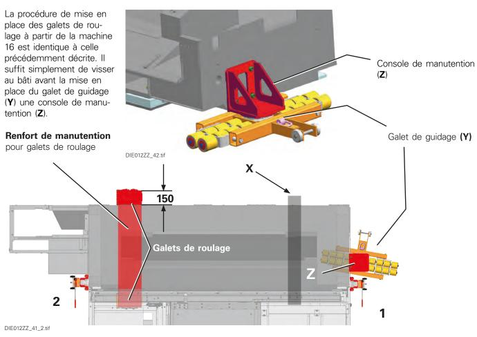
Fig.: Positions des crics hydrauliques et des galets de roulage (depuis la machine 16)
