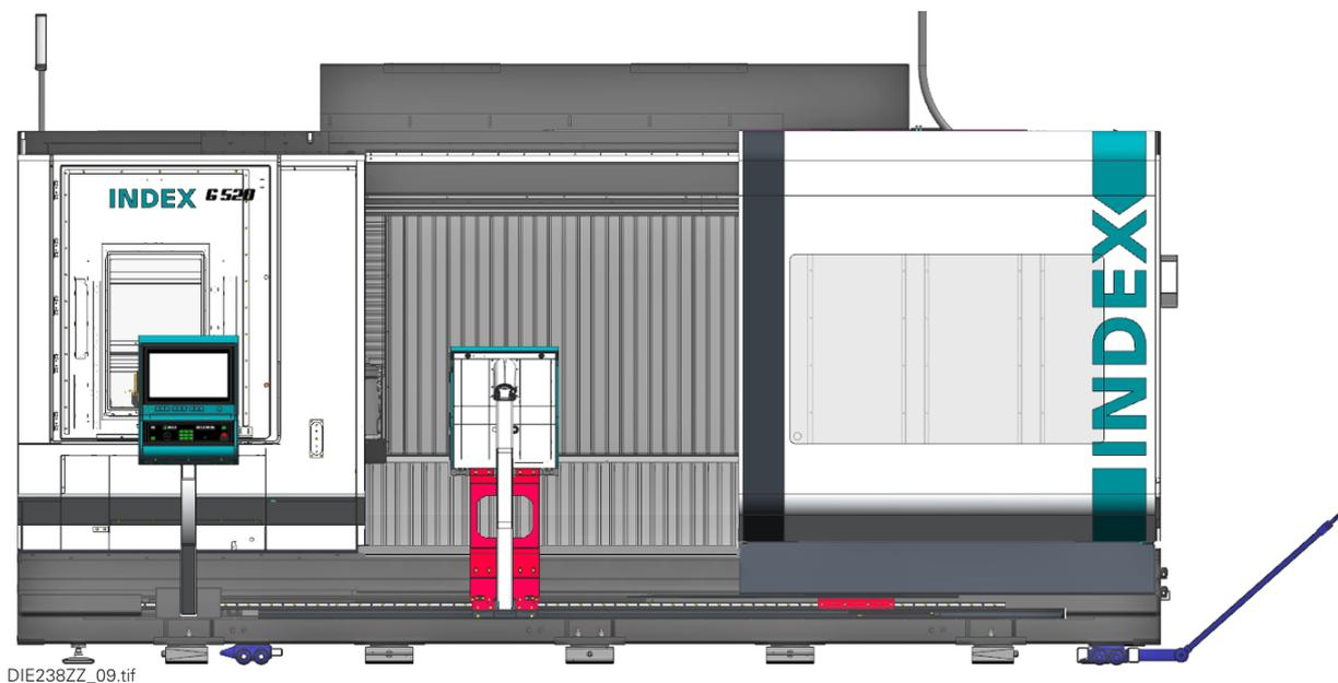
Transportrollen haben den Vorteil einer geringen Ladehöhe, so dass die Maschine mit Hydraulikhebern sowohl aufgeladen als auch abgeladen werden kann. Nachteilig sind die relativ kleinen Räder (Roller), die einen festen, ebenen Boden mit entsprechender Tragfähigkeit voraussetzen und sehr langsames, ruckfreies Fahren bedingen.
