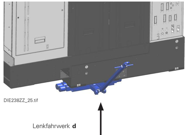
Abb.: Positionen für die Hydraulikheber und Transportrollen
