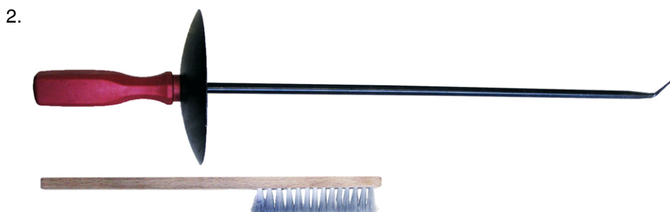
Beispiel: Werkzeug zum Entfernen von Spänen
