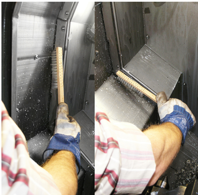
Exemple : 2 Balayer les petits copeaux et les autres saletés à l'aide d'un balai ou d'une brosse à copeaux, en partant du haut vers le bas.
