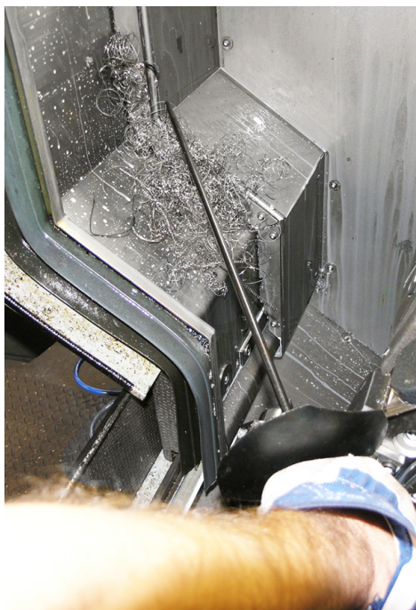
Exemple : 1 Éliminer les amas de copeaux à l'aide d'un outil approprié (par ex. crochet à copeaux)
