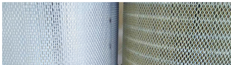
Nachfilter für Schneidölnebel links neu — rechts verbraucht
