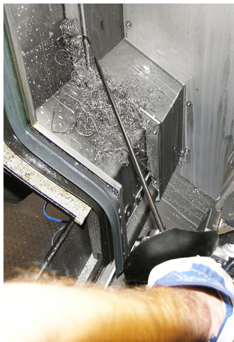
Beispiel: 1 Entfernen der Spänenester mit Hilfe geeigneter Werkzeuge (z.B. Spänehook)
