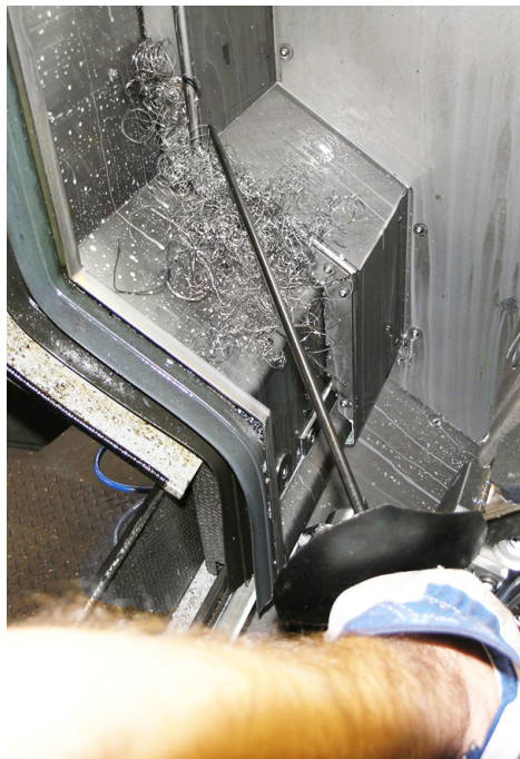
Beispiel: 1 Entfernen der Spänenester mit Hilfe geeigneter Werkzeuge (z.B. Spänehooken)
