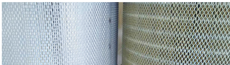
Filtre secondaire pour le brouillard d'huile de coupe neuf à gauche - usé à droite
