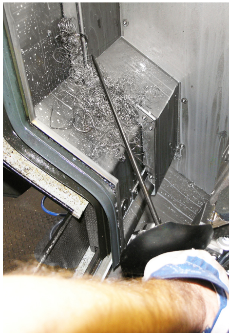
Beispiel: 1 Entfernen der Spänenester mit Hilfe geeigneter Werkzeuge (z.B. Spänehook)
