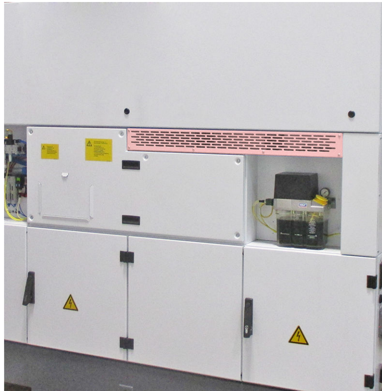
Beispiel: Lüfter Schaltschrank, TNL20
