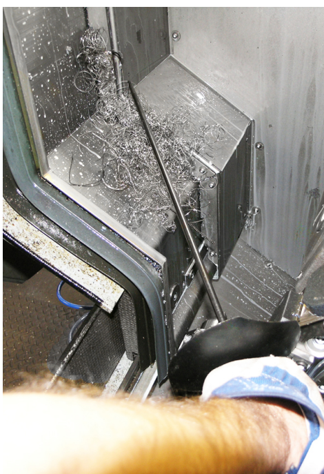
Exemple : 1 Éliminer les amas de copeaux à l'aide d'un outil approprié (p. ex. crochet à copeaux)
