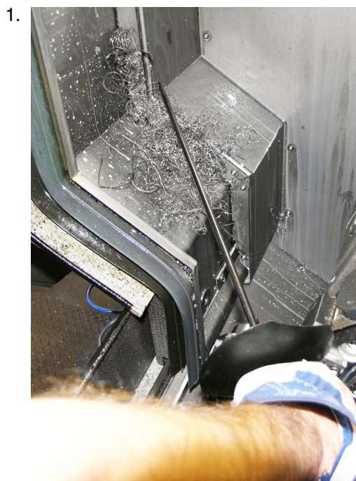
Exemple : 1 Éliminer les amas de copeaux à l'aide d'un outil approprié (p. ex. crochet à copeaux)
