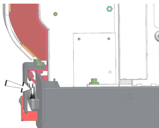
Exemple : TNL20, porte de l'espace de travail automatique, galets
