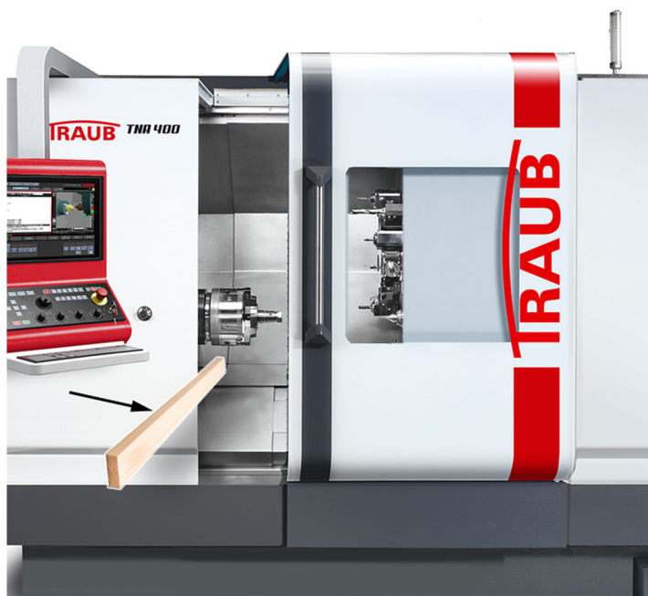
Exemple : Contrôle de la détection d'obstacles
