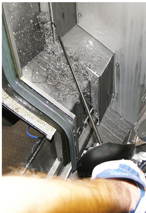
Beispiel: Entfernen der Spänenester mit Hilfe geeigneter Werkzeuge (z.B. Spänehook)
