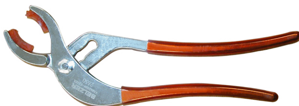
Exemple : Pince spéciale pour le serrage des branchements électriques et des capteurs sur les moteurs
