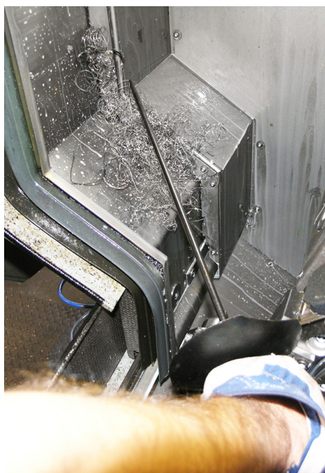
Exemple : Éliminer les amas de copeaux à l'aide d'un outil approprié (p. ex. crochet à copeaux)
