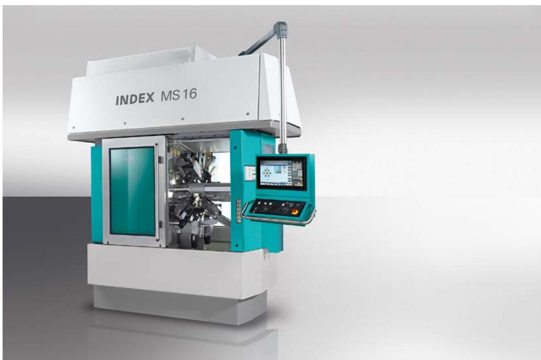
La machine INDEX MS16 Plus ne séduit pas seulement par le fait qu'elle allie la rapidité d'une machine à cames à la souplesse des techniques CNC, mais aussi parce que sa structure compacte (largeur de 1 300 mm) lui permet de se contenter de la même empreinte restreinte que celle occupée par les machines multibroches à cames. De plus, la MS16 Plus offre un confort de commande exceptionnel lors du réglage, ainsi que des
