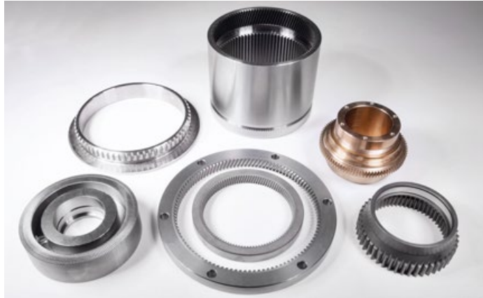
Power Skiving (Wälzschälen) auf dem Dreh-Fräszentrum INDEX G220: Dabei handelt sich um einen kombinierten Schäl- und Wälzprozess, bei dem sich das Werkzeug und das Werkstück synchron drehen. Das Hohlrad für ein dreistufiges Planetengetriebe besitzt eine schräge und eine gerade Innenverzahnung sowie ein außenliegendes Rändel zum Einpressen ins Gehäuse. Alle drei Verzahnungen entstehen durch Power Skiving. Fotos der Werkstücke: Framo Morat
