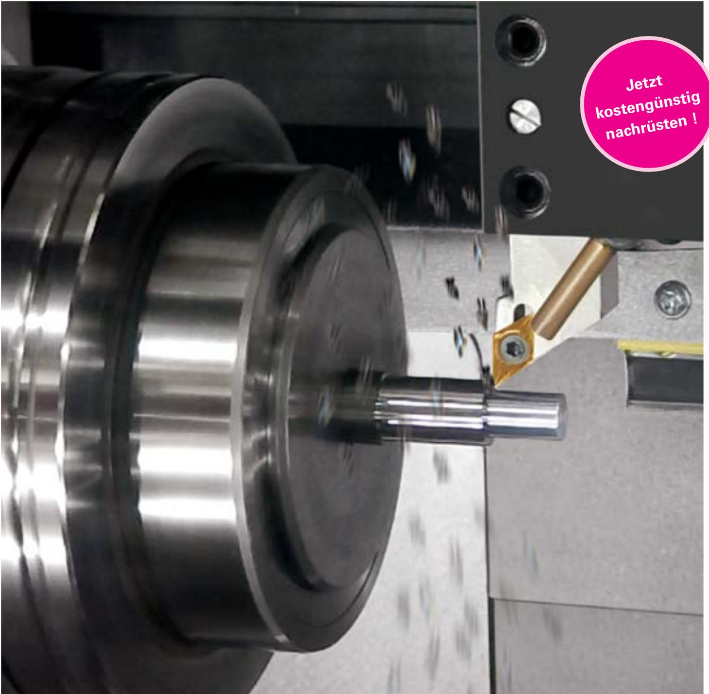
**Mit der neuen zyklusintegrierten Spänebruch-Software ChipMaster sorgt INDEX für einen kontrollierten Spänebruch bei der Bearbeitung (Längsdrehen, Plandrehen, Konturdrehen und Abstechen) aller eingesetzten Materialien.**
